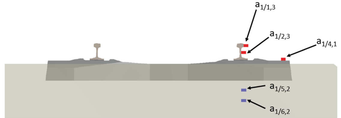
in Gleisrichtung: Beschleunigungssensoren Schiene/Schwellen/Schotter
